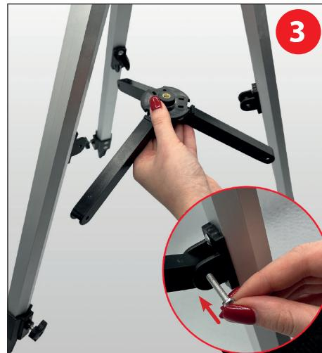
Убедитесь, что тренога устойчиво стоит на полу, поместите штатив для лотка **З** между ножками треноги и закрепите короткими болтами и наружными шестигранными гайками **И**. Теперь штатив можно закрепить и затянуть крыльчатые гайки на нем **К**.
