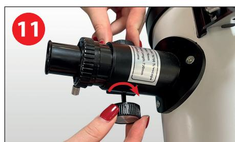
В время наблюдения резкость можно регулировать двумя колесиками, прилегающими к трубе.
