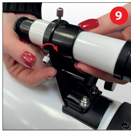
Вставьте видоискатель **В** в крепление и зафиксируйте.
