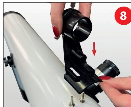
На трубе сверху Вы видите два болта. Туда будет установлен видоискатель с креплением. Снимите гайки с болтов, совместите крепление видоискателя **Г** с двумя болтами на трубе. Затем зафиксируйте
