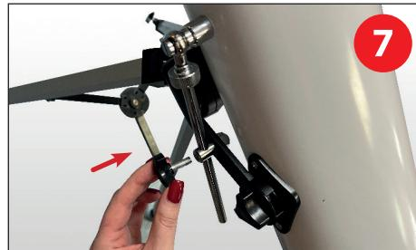
Закрепите стержень дополнительным винтом фиксации **О** в месте, где продевали стержень в отверстие.
